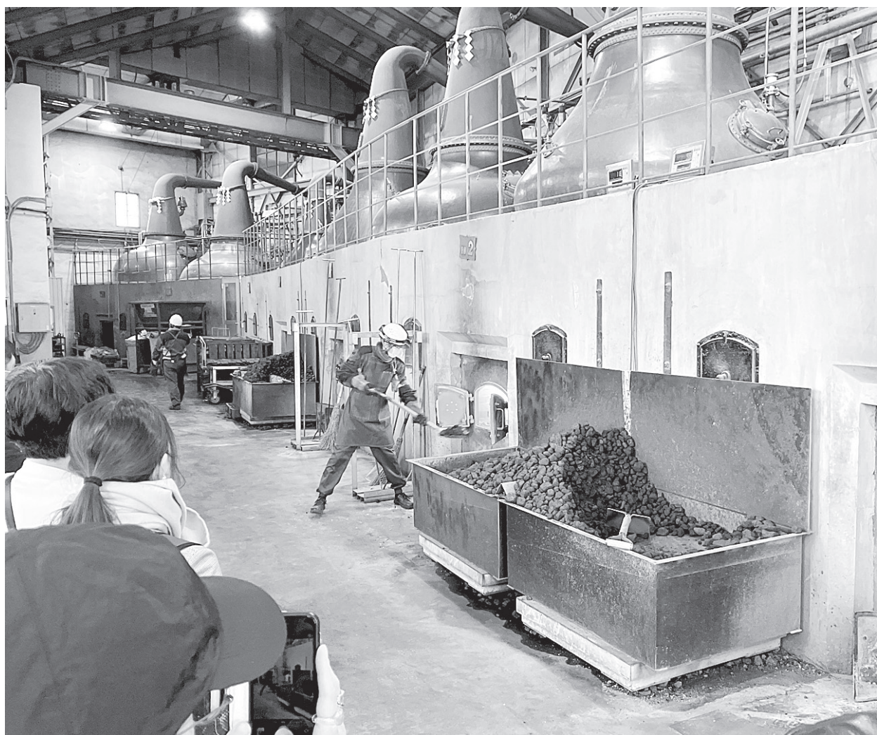
モロミの入った蒸留機（ホットスチル）を石炭で直に熱し、水とアルコールの沸点の差を利用してウイスキー成分を抽出する。2回繰り返してアルコール63%のモルトができる。ホットスチルの底のモロミの焦げが風味に加わる
